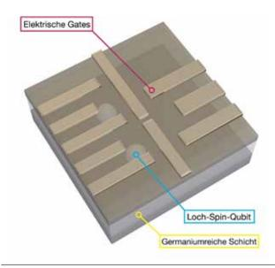
Loch-Spin-Qubits in germaniumreicher Schicht. Die beiden Löcher sind auf die nur wenige Nanometer dicke germaniumreiche Schicht beschränkt. Darüber bilden einzelne Drähte mit angelegten Spannungen die elektrischen Gates. Die positiv geladenen Löcher spüren den Einfluss der Drähte und können so innerhalb ihrer Schicht bewegt werden. © Daniel Jirovec
